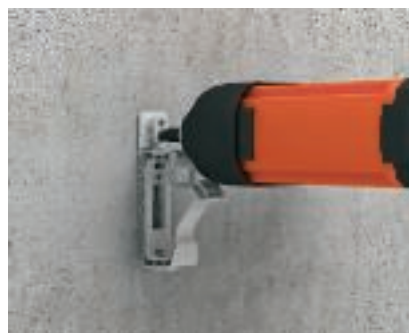
Montering på väggen med spikpistol Kabeluppsamlarens fästelement kan placeras på den gasdrivna spikpistolens huvud och fixeras automatiskt genom särskilda lameller. Fastsättningen sker utan ytterligare hjälpmedel direkt på väggen eller i taket med hjälp av den spikpistolen.
