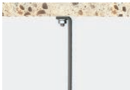
Belastningsfall 4: Fastskruvad under taket med skruv och bricka Minsta brottbelastning enligt kolumn C
