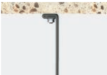
Belastningsfall 5: Fastskruvad med skruv under taket, dubbel bandände, fri bandände nedåt Minsta brottbelastning enligt kolumn B
