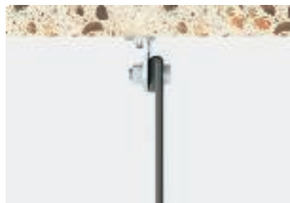
Belastningsfall 3: Fastskruvad på konsol, dubbel bandände, fri bandände på insidan Minsta brottbelastning enligt kolumn A
