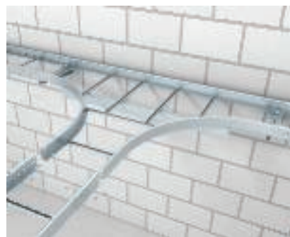
Installation av ett T-stycke Installation av ett T-stycke av typen LT för en horisontell övergång. I tillbehörsområdet ska ytterligare konsoler användas.
