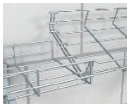
Skarvförbindning trådstege Magic® Upprättande av en skruvlös skarvförbindning för trådstegen typ GR-Magic® genom att två produktlängder sticks in i varandra.
