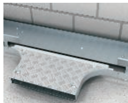
Installation T-stycke För installation av T-stycket typ RAA tas en bit bort på kabelrännans gavel och T-stycket infogas.
