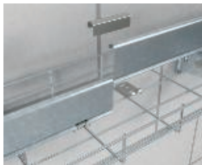
Skruvlös mellanväggsfastaättning Skruvlös fastaättning av en mellanvägg i trådstegar med klämstycke KS GR. Skruvlös skarvning av trådstegar sker med hjälp av mellanväggsskarv TSGV.
