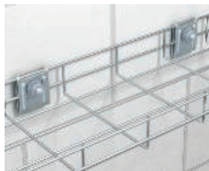
Väggfäste av trådstegar Väggfäste av trådstegar med konsol av typen K 12 1818. Maximal trådstegsbredd 200 mm.
