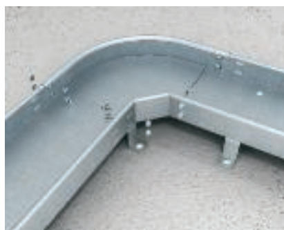
Installation böj Böjar med bredden 100 till 300 mm skjuts in på sidogaveln via förbindningen; vid bredder 400 till 600 mm behövs standardförbindningar.
