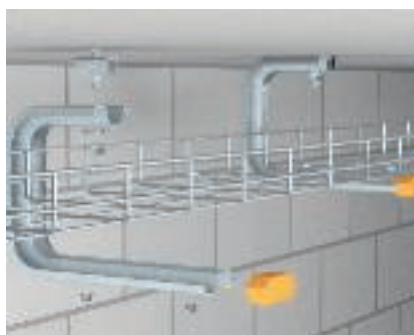
Takmontering med TP-vägg- och takbygel Takmontering av en trådstege med TP vägg- och takbygel typ TPDG. Trådstegen fästs utan skruvar på takbygeln.
