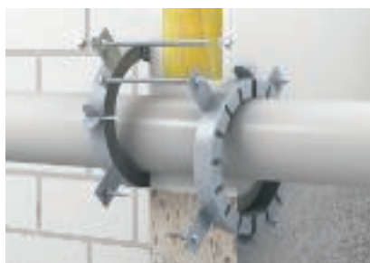
Excentrisk montering med max. 3 steg större rörmanschetter
